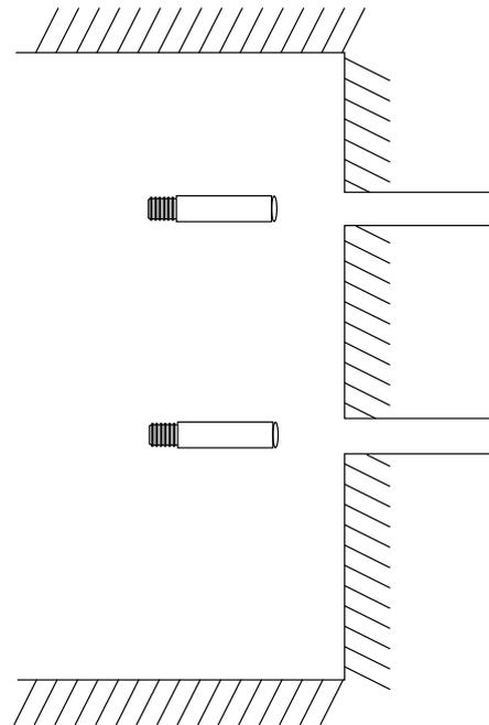
4. Setzen Sie geeignete Dübel in die Bohrlöcher ein.
