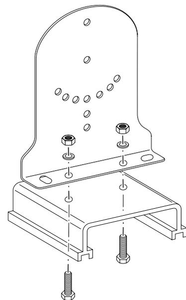
2. Verbinden Sie die zweite Gerätehalterung mit dem zweiten Befestigungswinkel.
