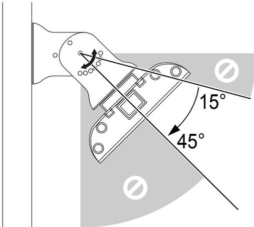
8. Verbinden Sie die Befestigungswinkel am Gerät und an der Wand / Decke im gewünschten Neigungswinkel miteinander. Verwenden Sie für jede Seite je zwei Kreuzschlitzschrauben, zwei kleine Sechskantmuttern (M4) und Federringe (Ø 4,1 mm).
