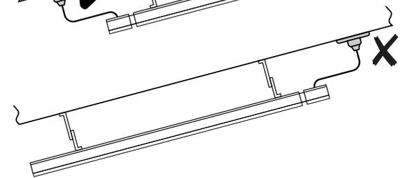
5. Ziehen Sie die zwei Flügelschrauben am Gerät fest, um die Gerätehalterungen zu arretieren.
