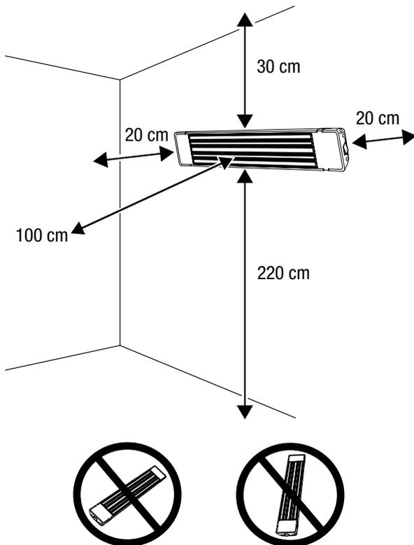
1. Messen Sie den Abstand der Halterungen am Gerät und verwenden Sie diesen entsprechend für die Abstände der Bohrlöcher.
