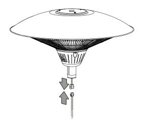
5. Faites passer le cordon secteur par le haut à travers le tube monté et le socle.
