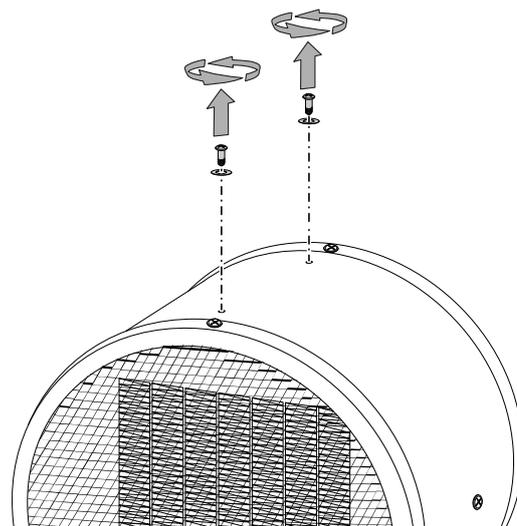
2. Monte el asa de transporte mediante los dos tornillos y las arandelas.
