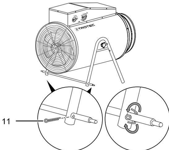
4. Montez les roues (12) aux deux extrémités de l'axe et fixez-les au moyen des écrous et des rondelles.
