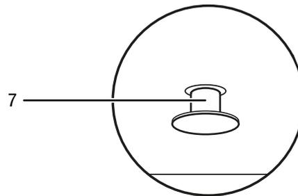
Apenas após a inserção completa do interruptor de proteção contra queda (7) para dentro do aparelho pode utilizar o aparelho. Ao posicionar o aparelho sobre uma superfície adequada este interruptor liga-se automaticamente.
