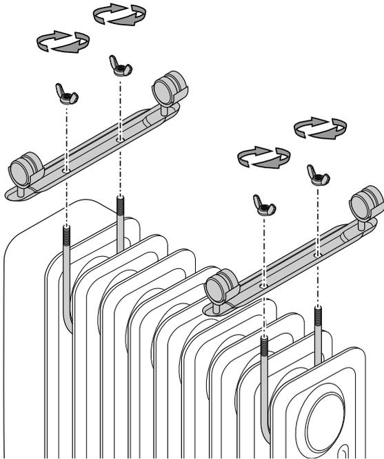
6. Verschrauben Sie Montageplatten, Flügelmutter und U-Bolzen. Achten Sie auf festen Sitz der Montageplatten. Diese sollten gleichmäßig auf den Rippen aufliegen, damit das Gerät gerade stehen kann.
