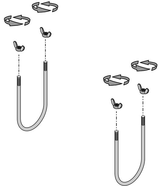
4. Setzen Sie jeweils einen U-Bolzen zwischen die ersten beiden und letzten beiden Rippen an der Unterseite des Gerätes.
