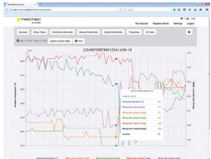
In de detailweergave wordt het droogverloop weergegeven voor de gekozen tijdsperiode. Een alternatieve tabelweergave van de meetwaarden is ook zonder problemen mogelijk.
