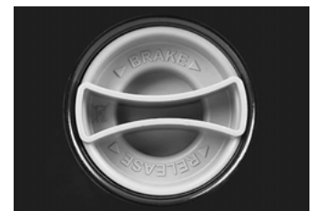
Aan de achterzijde centraal in de as geïntegreerd remsysteem
