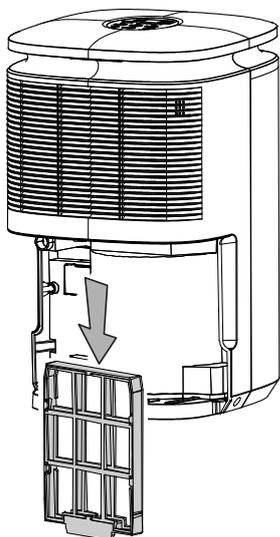
2. Pulire il filtro con un panno morbido, senza pelucchi e leggermente umido. Nel caso in cui il filtro dovesse essere molto sporco, lavarlo con acqua calda mischiata a un detergente neutro.
