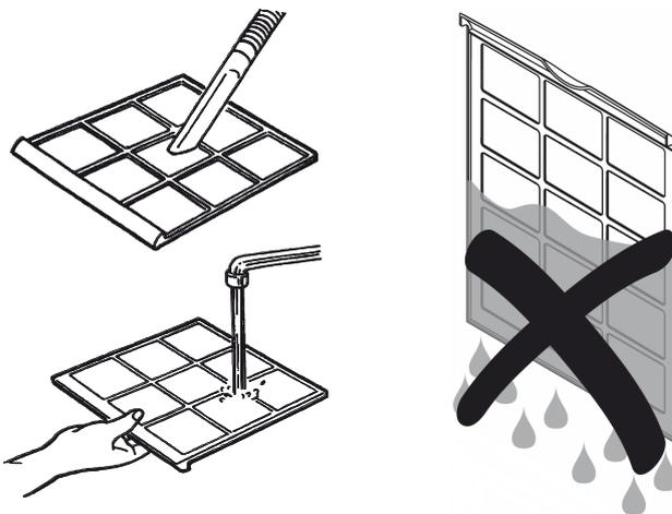
3. Far asciugare completamente il filtro. Non inserire un filtro bagnato nel dispositivo!
