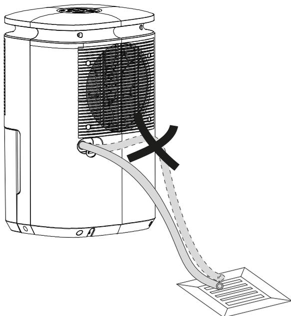
Rimuovere il tubo flessibile, se si desidera nuovamente raccogliere la condensa con il contenitore di condensa. Prima dello stoccaggio, far asciugare il tubo flessibile. Il tubo flessibile può essere allacciato per un utilizzo continuo in qualsiasi modalità di funzionamento.
