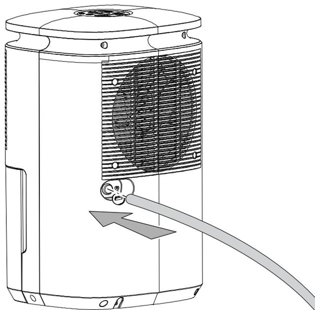
3. Portare l'estremità del tubo flessibile a uno scarico adatto (ad es. un pozzetto di raccolta o un contenitore di raccolta sufficientemente grande). Fare attenzione, il tubo flessibile non deve essere piegato.
