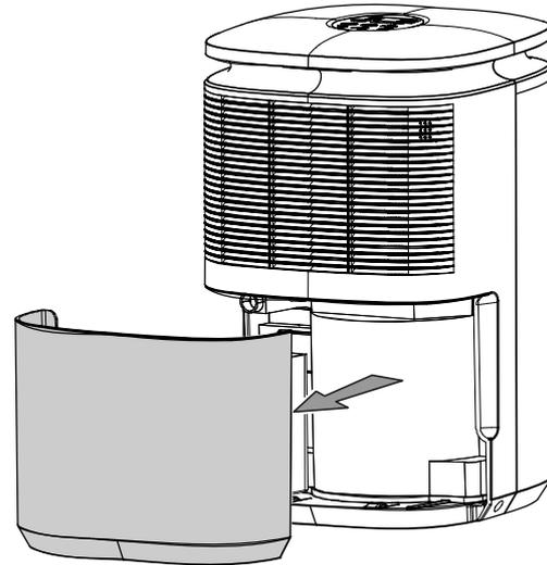
2. Esvazie o tanque de água condensada através de um dreno ou em uma pia.
