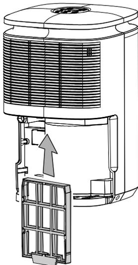
**Coloca o tanque de água condensada**
