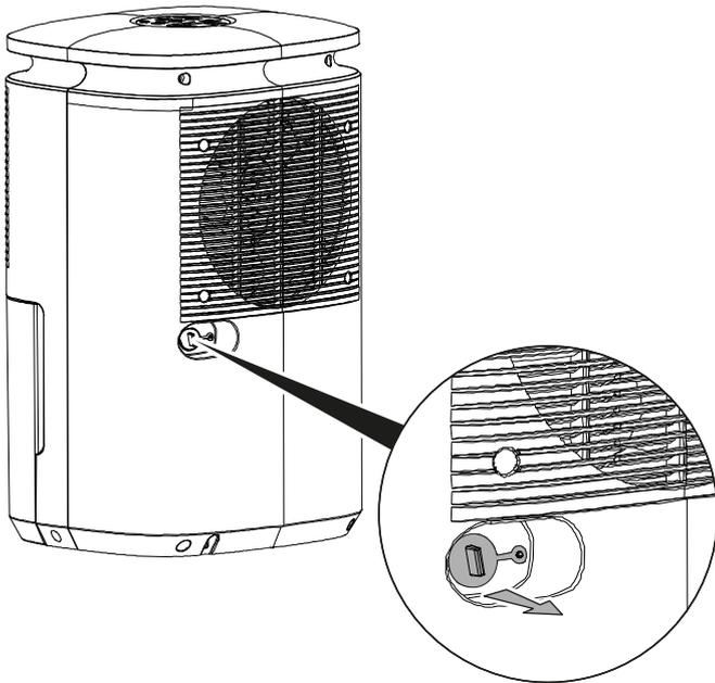
2. Introduza uma extremidade da mangueira na conexão da mangueira.
