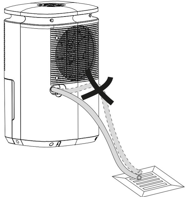
Remover a mangueira se quer recolher o condensado através do tanque de água condensada. Deixar secar a mangueira antes do armazenamento. A mangueira pode ser conectada em qualquer modo operacional para o funcionamento permanente.
