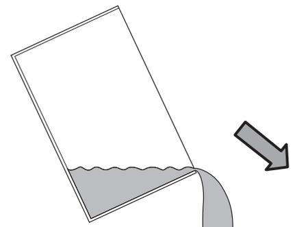
3. Lavar o tanque com água limpa. Limpe o tanque em intervalos regulares com um produto de limpeza brando (nenhum detergente!).
