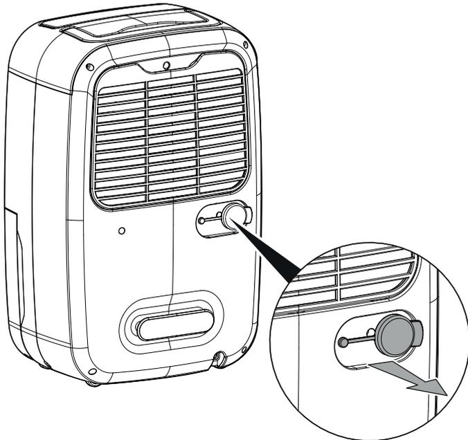
3. Conecte uno de los extremos de la manguera en la conexión de manguera.
