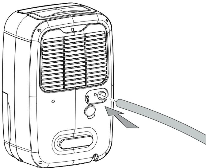
4. Conecte el otro extremo de la manguera a un desagüe apropiado (por ejemplo un sumidero o un recipiente colector suficientemente grande). Asegúrese de que la manguera no se pueda doblar.
