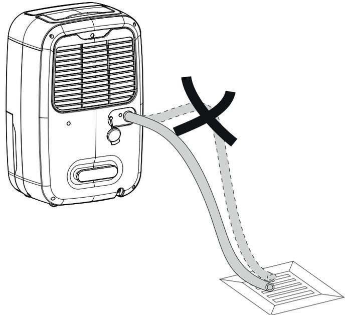
Cuando desee volver a recoger el agua condensada en el depósito quite la manguera. Deje secar la manguera antes de guardarla. La manguera puede ser conectada de manera permanente en cualquier modo de funcionamiento.
