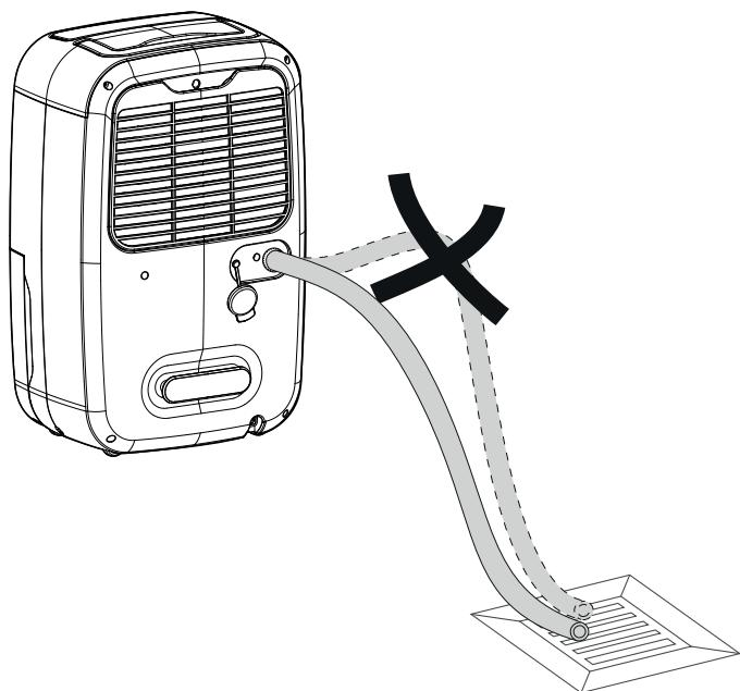
⇒ Ako kondenzat ponovo želite skupljati preko posude za kondenzat, uklonite crijevo. Pustite da se crijevo osuši prije skladištenja. Crijevo se može trajno priključiti u bilo kojem načinu rada.
