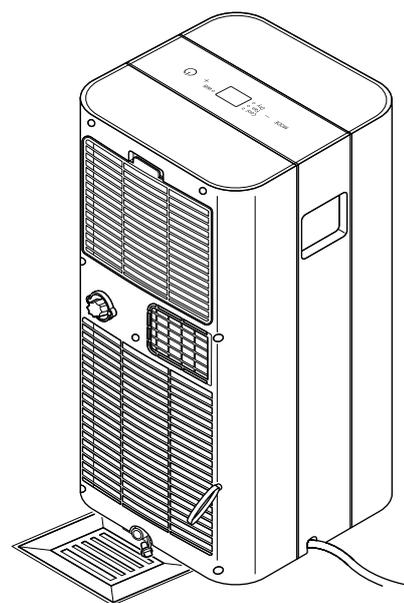
2. Entfernen Sie den Gummistopfen vom Kondensatablass.
