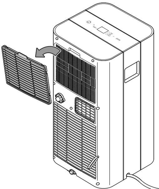
2. Säubern Sie den Filter mit einem weichen, fusselfreien, leicht angefeuchteten Tuch. Sollte der Luftfilter stark verschmutzt sein, säubern Sie ihn mit warmem Wasser, vermischt mit neutralem Reinigungsmittel.
