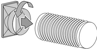
2. Schieben Sie den Schlauchadapter mit Abluftschlauch von der Seite in den Anschluss Abluftschlauch des Klimagerätes.
