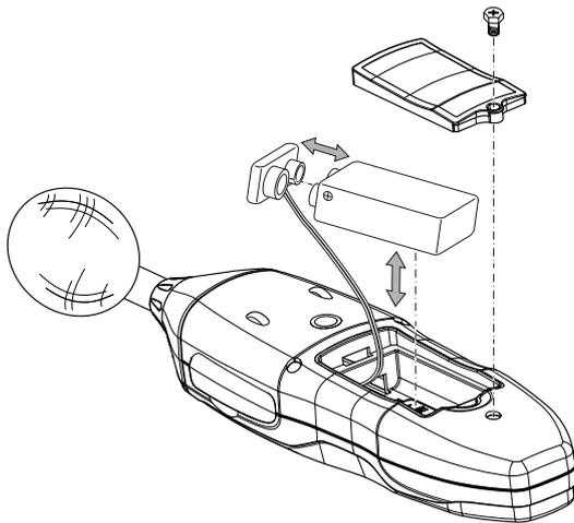
1. Aprire il vano batterie sul retro, svitando la vite sul coperchio.
