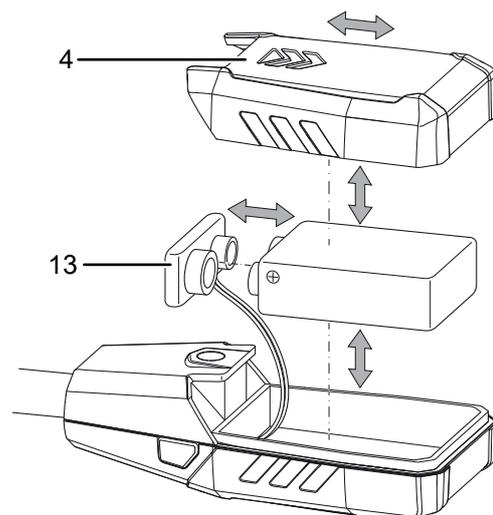
1. Deslice la tapa del compartimento de la pila (4) hacia fuera del aparato.
