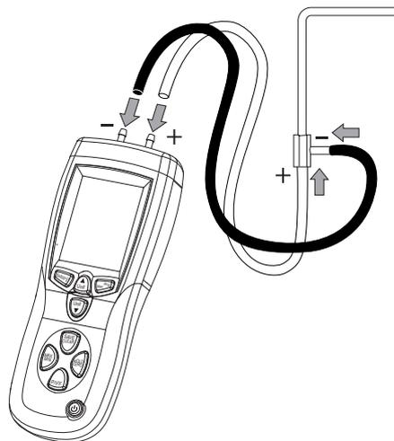
3. Нажмите кнопку *HOLD/ZERO* (9) примерно на 2 с, чтобы сбросить измеряемые значения на нуль.
