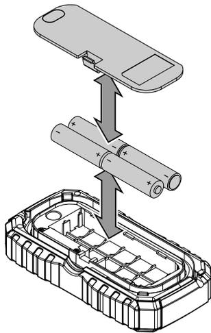
3. Remettez le couvercle en place sur le compartiment à piles.
