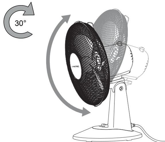
⇒ O ângulo de inclinação do ventilador é ajustado e o fluxo do ar concentra-se no ângulo de inclinação selecionado.
