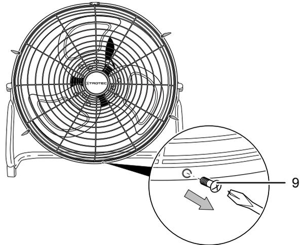
3. Pour fixer à nouveau la grille de protection sur le ventilateur après le nettoyage, commencez par poser la vis de liaison (9), puis refermez les quatre clips de fixation.
