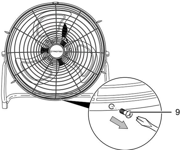
3. Kako biste zaštitnu rešetku nakon čišćenja ponovno pričvrstili na ventilator, postavite spojni vijak (9) pa ponovno priključite četiri učvršne stezaljke.
