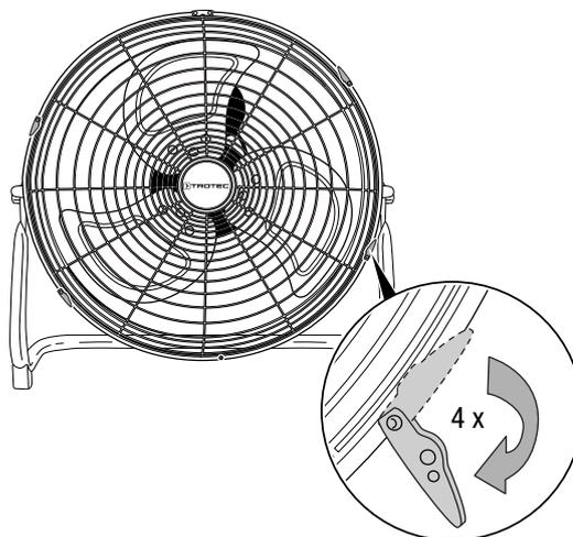
2. Otpustite spojni vijak (9) ispod zaštitne rešetke (1).
