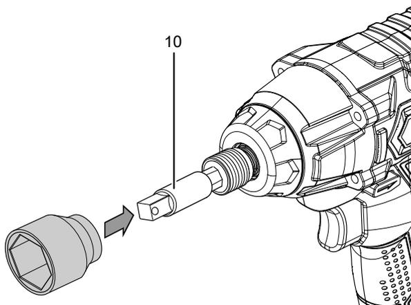
3. Проверьте прочность крепления торцевой головки.
