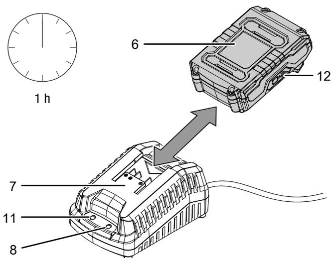
2. Вставьте вилку сетевого кабеля быстрозарядного устройства (7) в сетевую розетку с надлежащим предохранителем.
