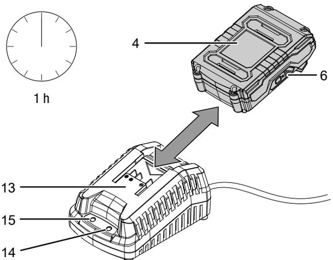
2. Enchufe la clavija de alimentación del cargador rápido (13) a una toma de corriente debidamente protegida.
