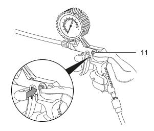
2. Отсоедините рычажный быстродействующий зажим или используемый адаптер от надуваемого предмета.
