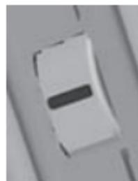
Im Gegensatz zu konventionellen Handmessgeräten besitzt das Messgerät kein Tastenfeld, sondern ein so genanntes „Daumen-Rad“ auf der linken Seite des Gerätes.
