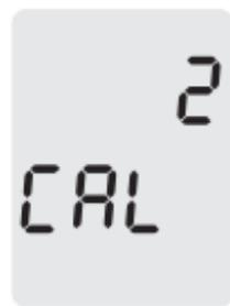
Halten Sie nun zum Nullabgleich der Signalamplitude die Mittelposition → des Daumenrads so lange gedrückt, bis nach dem Start-Countdown in der unteren Displayanzeige „CAL“ erscheint.
